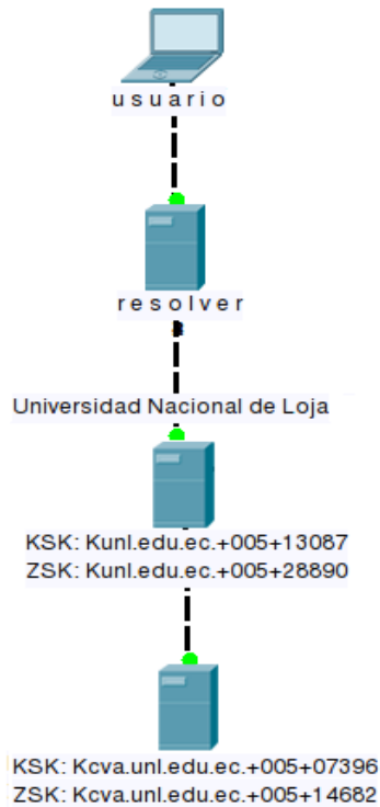
Fig. 3. Esquema del aseguramiento de las zonas DNS.
